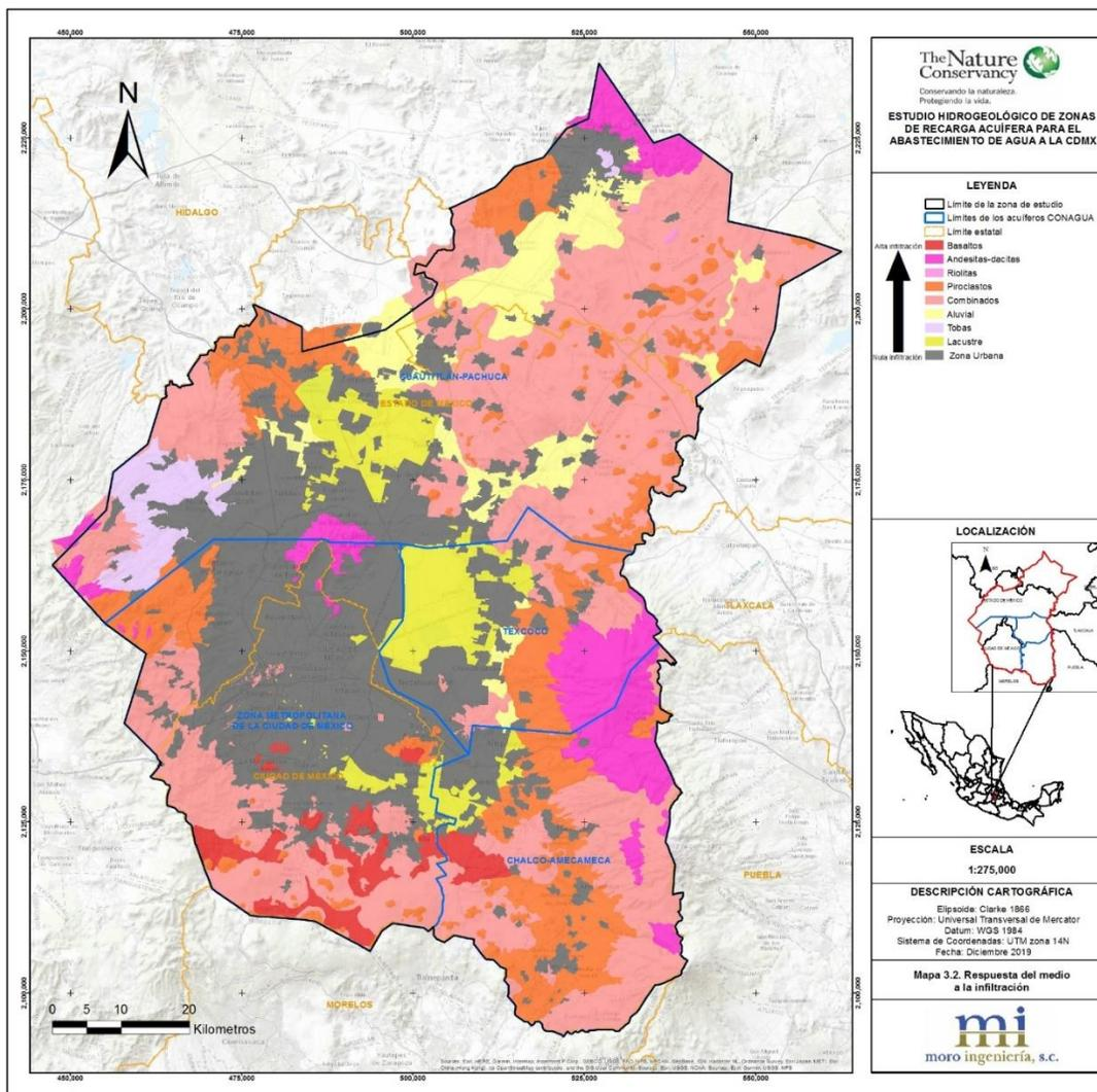
Figura 3.14. Materiales clasificados en función de su respuesta a la infiltración
