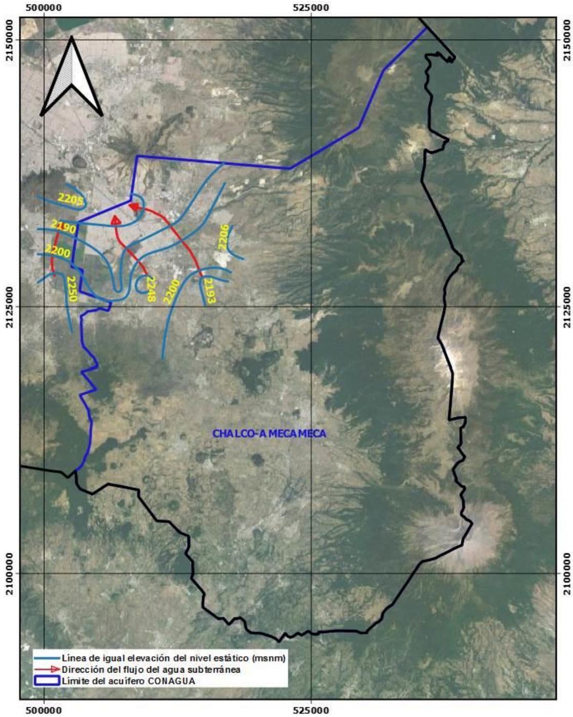
Figura 3.6. Configuración de elevación del nivel estático para el Acuífero Chalco-Amecameca
