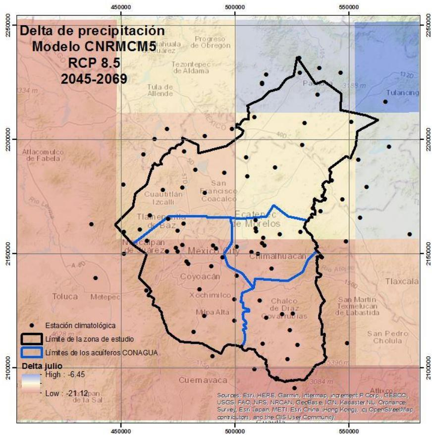
Figura 3.34. Desviación de la precipitación conforme al modelo CNRMC-M5 con RPC de 8.5 para dos periodos
