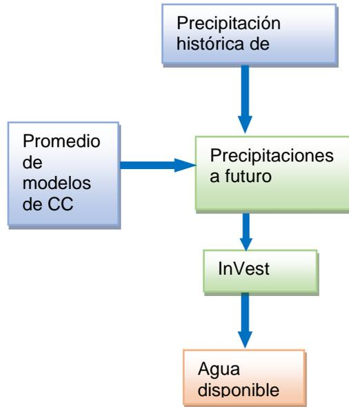
Figura 3.38. Diagrama de procesamiento de los modelos y los datos de precipitación de las estaciones
