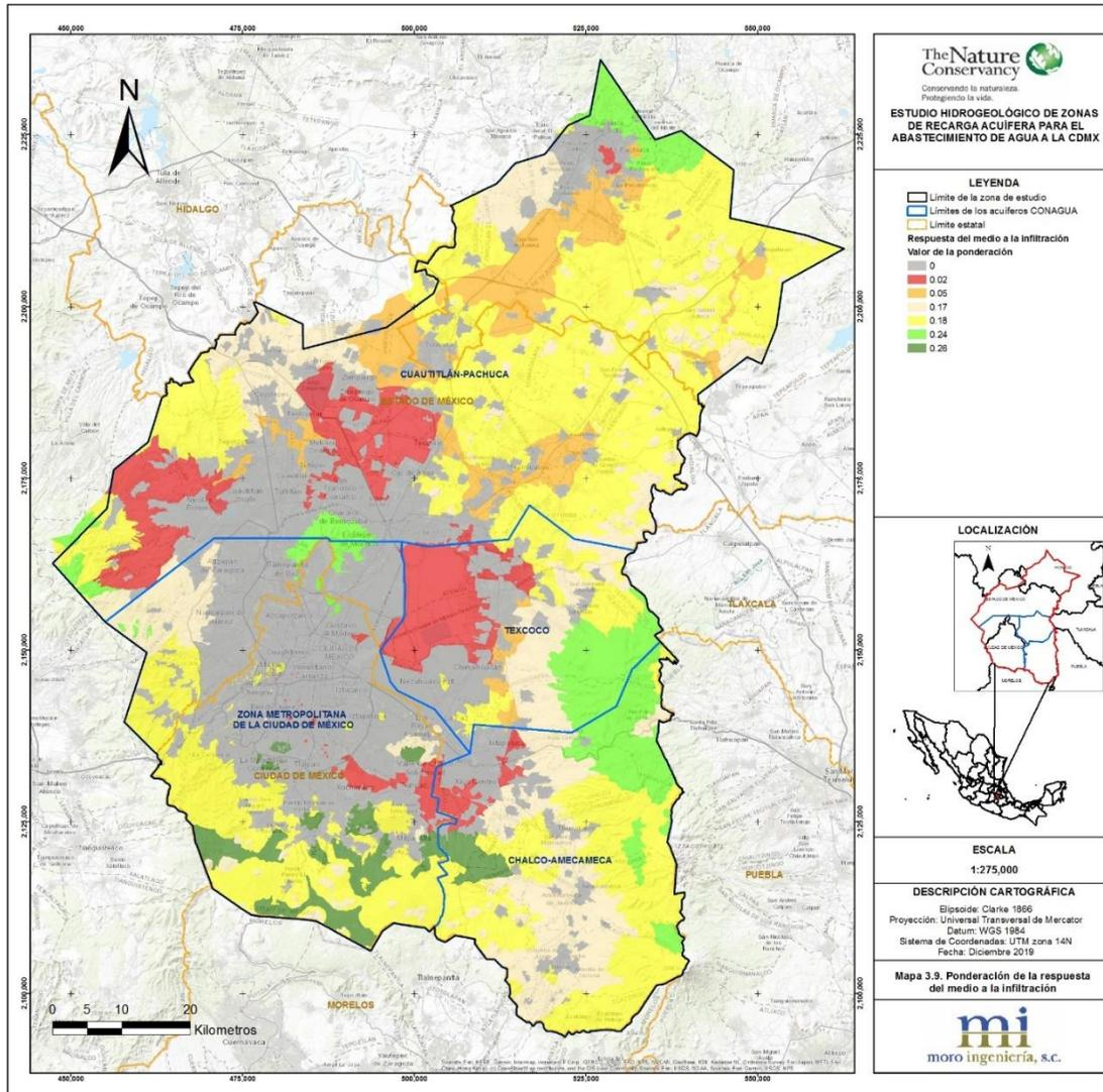
Figura 3.26. Respuesta del medio a la infiltración, resultado de la ponderación
