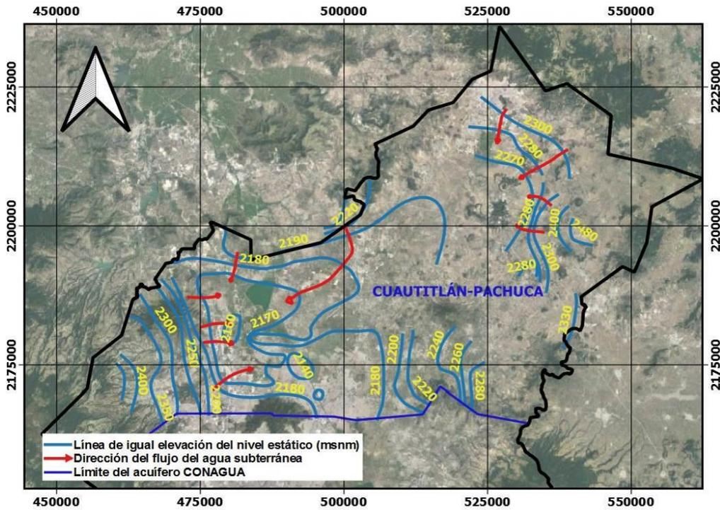
Figura 3.12. Configuración de elevación del nivel estático, Acuífero Cuautilán-Pachuca
