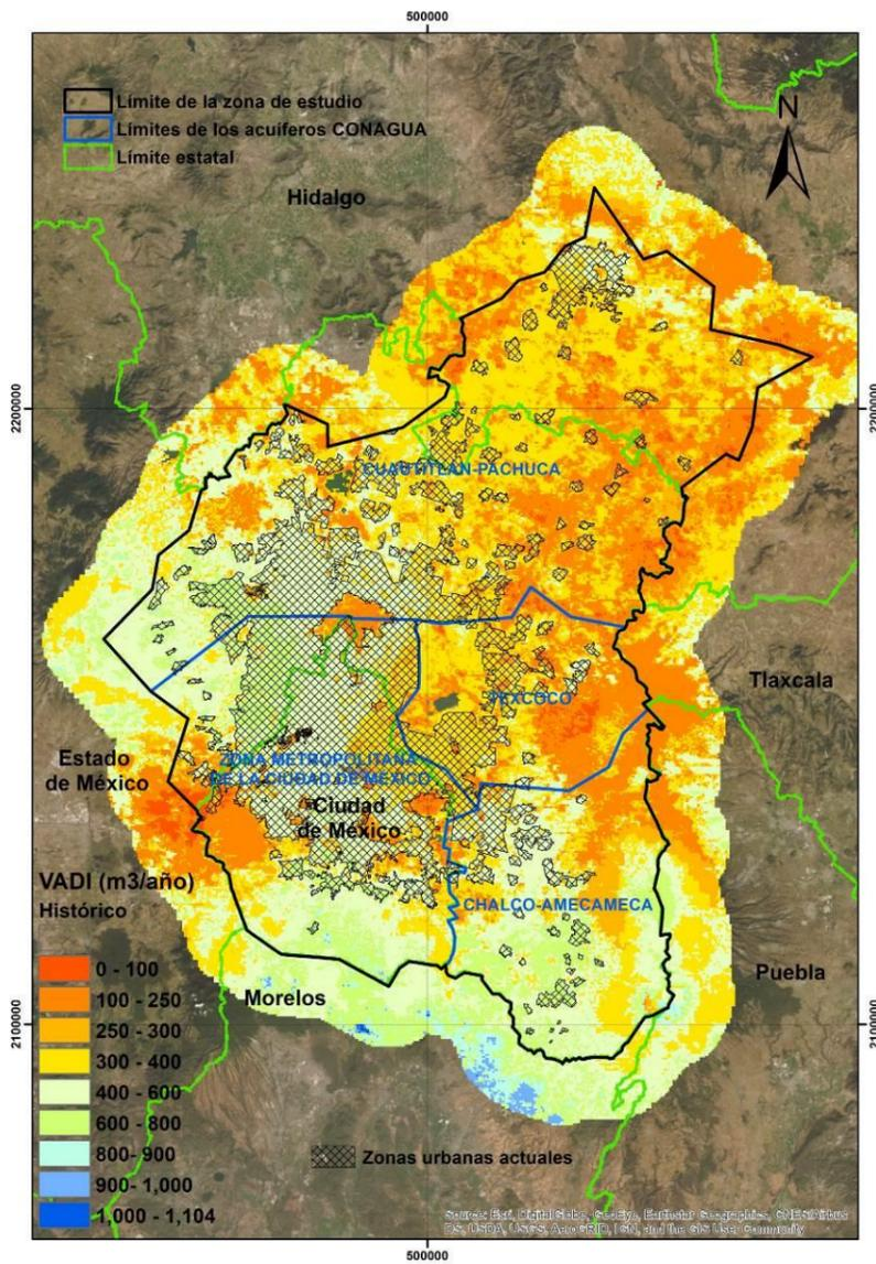
Figura 5.8. Condición actual del agua disponible para infiltración
