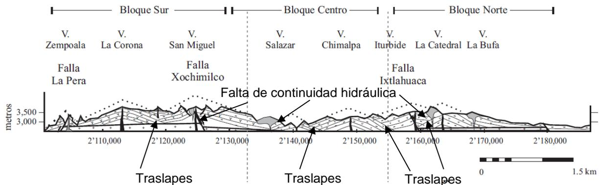
Figura 3.22. Sección geológica que muestra la falta de continuidad litológica e hidráulica de los materiales volcánicos en la Sierra de Las Cruces
